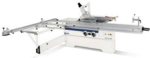
**SCIE CIRCULAIRE À LAME INCLINABLE**
